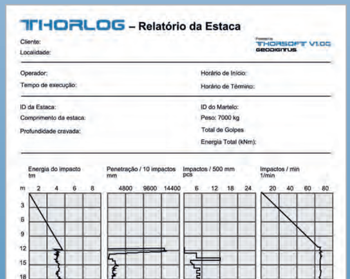
Relatório da estaca incluindo gráficos do processo de cravação.
